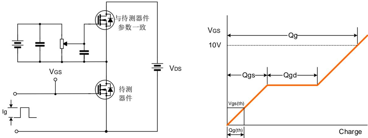
开关时间测试电路及波形图
