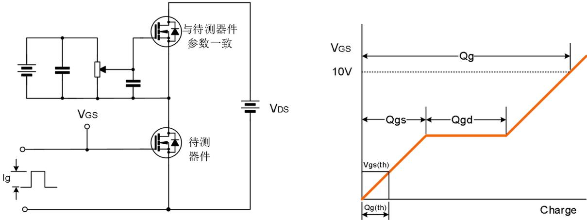
开关时间测试电路及波形图
