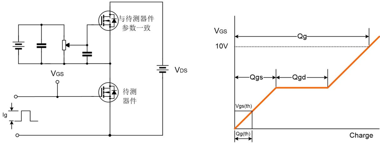
开关时间测试电路及波形图
