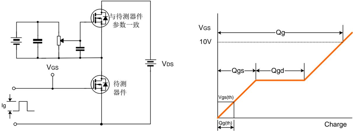
开关时间测试电路及波形图
